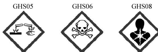
Rys. 1. Piktogramy hasła ostrzegawczego: „Niebezpieczeństwo”. Piktogramy określone w rozporządzeniu WE nr 1272/2008 (CLP) mają czarny symbol na białym tle z czerwonym obramowaniem, na tyle szerokim, aby było wyraźnie widoczne
