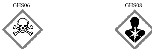
Rys. 1. Kody hasła ostrzegawczego „Niebezpieczeństwo”. Piktogramy określone w rozporządzeniu WE nr 1272/2008 mają czarny symbol na białym tle z czerwonym obramowaniem
