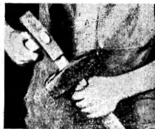
Prawidłowy sposób zaklinowywania młotka
