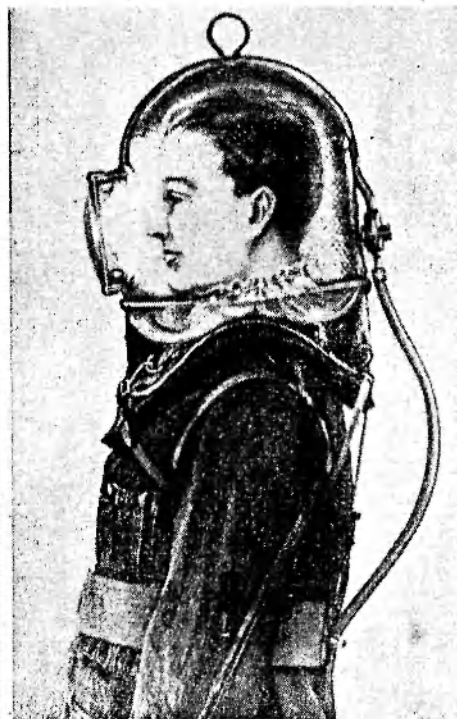
Helm z doprowadzeniem powietrza pod helm
