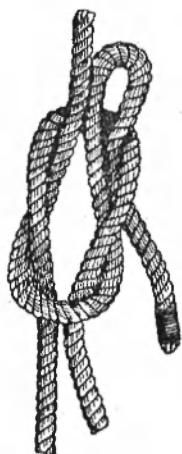
Rys. 52. Zabezpieczenie dwóch końców liny opaską: a, b, c, d) kolejność wykonania opaski
