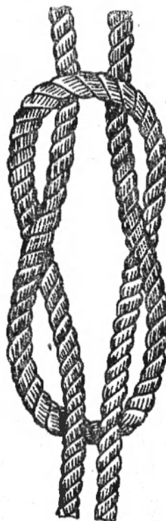
Rys. 50. Węzeł prosty przed zaciągnięciem
